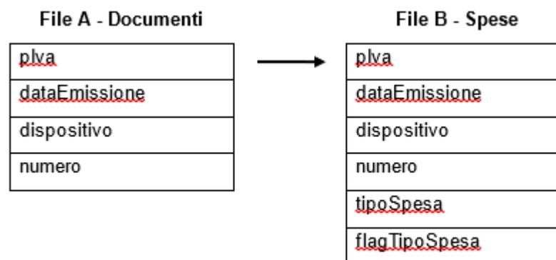
In fase di simulazione, il primo tipo di controllo applicato riguarda la conformità allo schema XSD del singolo file; la non corrispondenza di un solo record del file allo schema XSD comporta lo scarto dell’intera fornitura.
